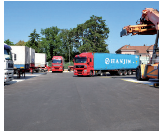
Ein «Brandi-Lkw» mit mobilem Containerkrangerät.
